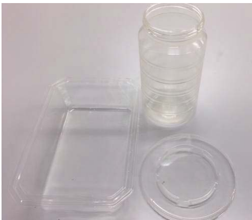
ポリ乳酸の透明性を維持したまま結晶性（耐熱性）を高めた成形品。
